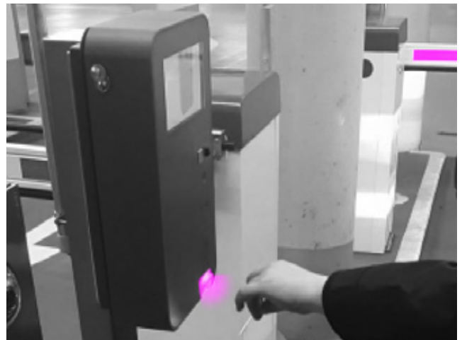
14) An der 2. Säule Besucherticket mit Strichcode nach oben wie gezeigt in den Kartenlaser halten. Schranke öffnet, wenn Laser den Strichcode des Tickets korrekt gescannt hat.
